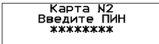
Рисунок 2.7 Пример экрана ввода PINкода для карты в слоте 2.
