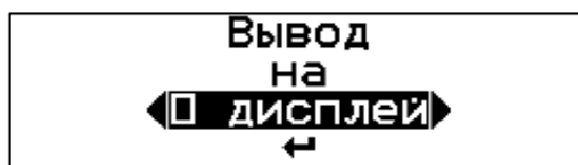
Рисунок 2.13 Выбор вывода отчета на дисплей тахографа
