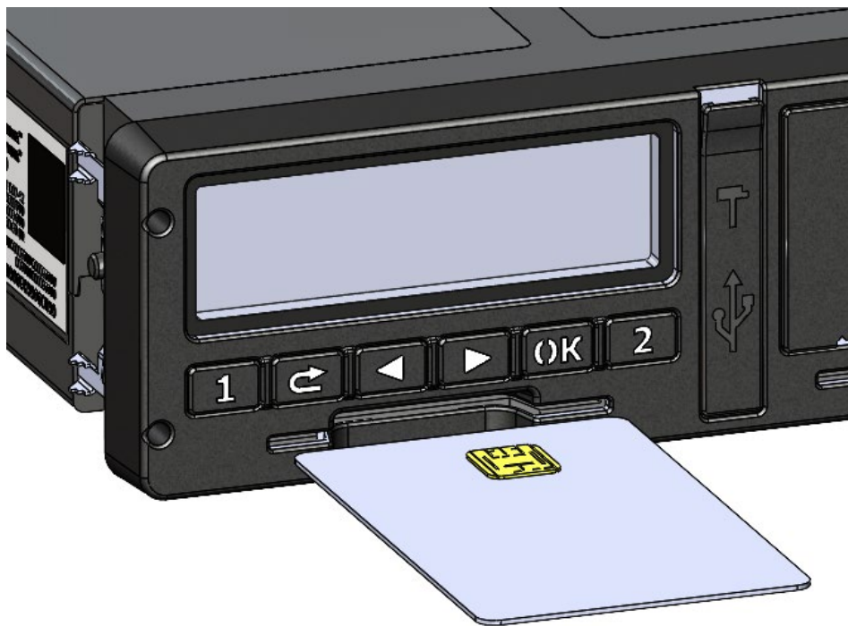
Рисунок 7. Установка карты в тахограф
