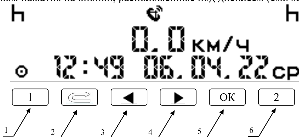
Рисунок 4. Главный экран меню тахографа и кнопки управления
